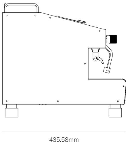
Arteq Mini Twin è la nostra macchina combinata compatta ed ergonomica, collocabile in ogni ambiente, anche il più ridotto, e di facile manutenzione. Dotata di due caldaie indipendenti, ha un sistema a capsule a doppia erogazione per il caffè e genera acqua e vapore. I due gruppi di caffè funzionano sia in modo autonomo l'uno dall'altro che contemporaneamente, garantendo il massimo risparmio energetico. Perfetta per creare l'angolo caffè in bar, B&B, chioschi e piccole comunità.
